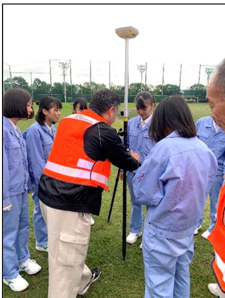
生徒の皆さんは、GNSS測量機を操作し、VRSネットワーク型RTK法によりグラウンドの埋設物を探索しています
